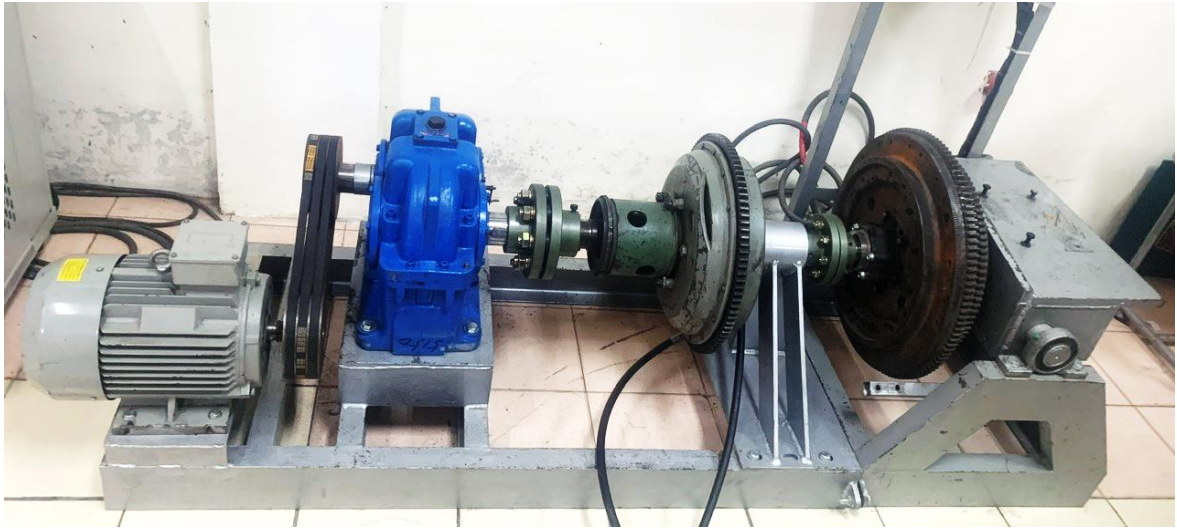
Hình 3.19. Thiết bị thử nghiệm độ bền mòn đĩa ma sát ly hợp chính
