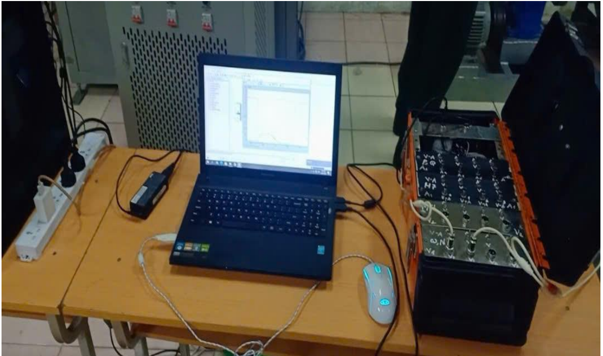
Hình 3.17. Kết nối các thiết bị đo và cảm biến với bộ NI-USB 6009
