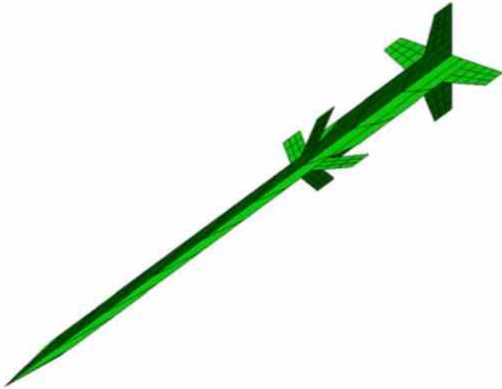
Hình 1. 5. Mô hình chia lưới theo phương pháp panel [27].
