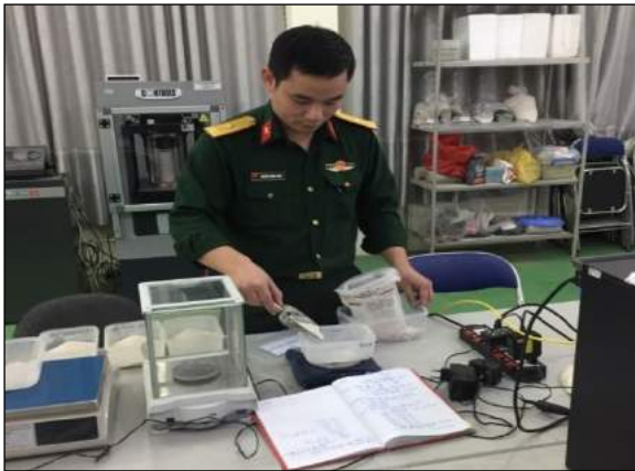
Hình 2.4. Xác định thành phần hạt mẫu thí nghiệm theo cấp phối thiết kế
