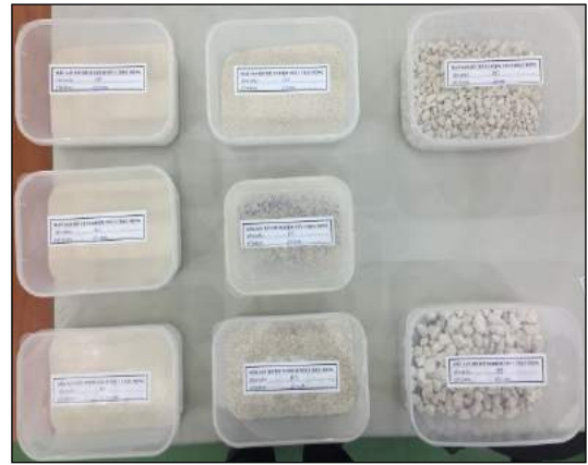
Hình 2.4. Xác định thành phần hạt mẫu thí nghiệm theo cấp phối thiết kế
