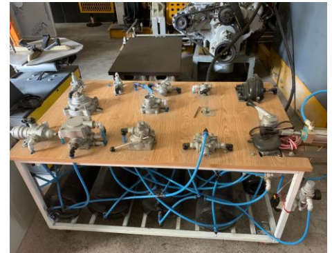
Hình 4.3. Sa bàn hệ thống phanh khí nén nhiều dòng của xe Kamaz-5320
