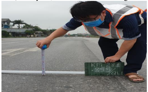
Hình 4.3: Đo đạc vết lún bánh xe QL.1 (Km281+895), 4/2022
