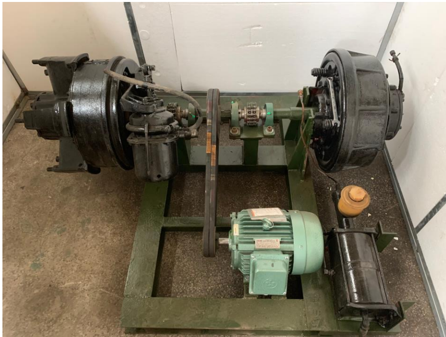
Hình 4.13. Thiết bị điều khiển quay tang phanh
