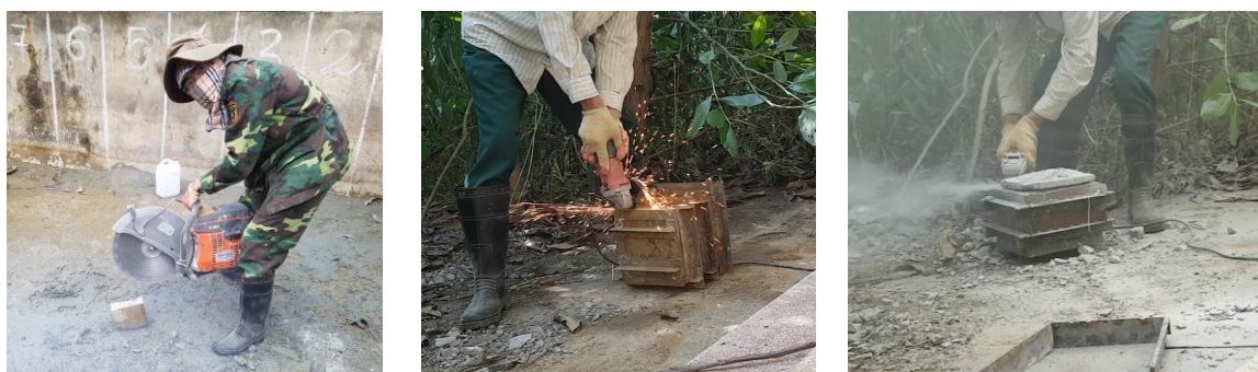
Hình 4.13. Cưa các mẫu thí nghiệm sau nổ
