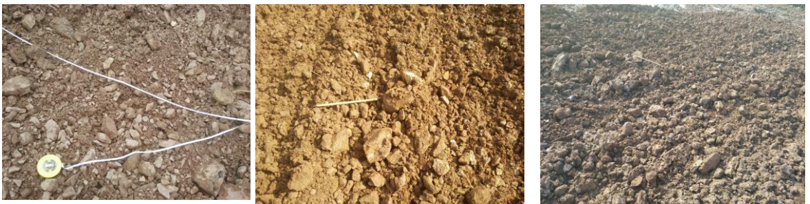
Hình 4.40. Kết quả nổ thí nghiệm bài TN2
