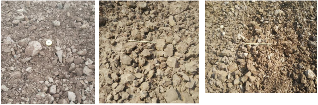
Hình 4.41. Kết quả nổ thí nghiệm bài TN3
