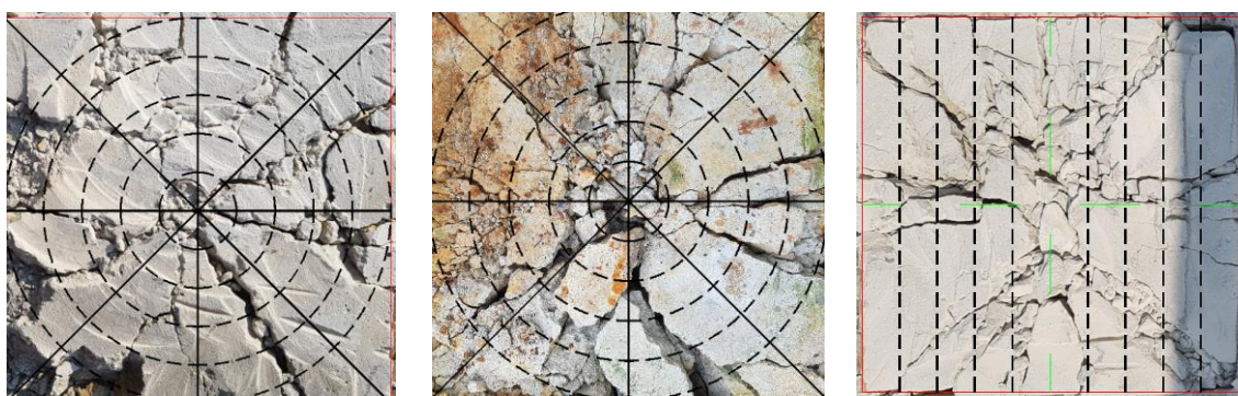
Hình 4.13. Cưa các mẫu thí nghiệm sau nổ
