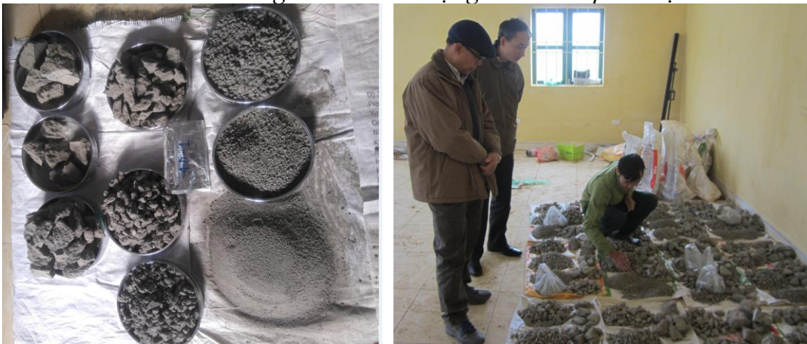
Hình 4.9. Phân loại thành phần hạt của các mẫu thí nghiệm
