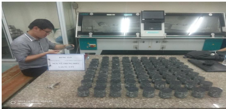
Hình 2.12: Kiểm tra kích thước mẫu sau khi chế tạo
