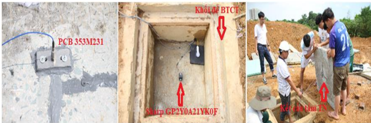
Hình 3.19. Thí nghiệm xác định đặc trưng động học tấm BTCT
