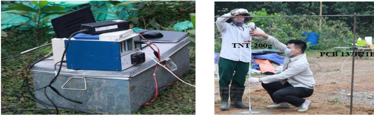
Hình 3.2. Bố trí thí nghiệm đo áp lực nổ không khí hiện trường
