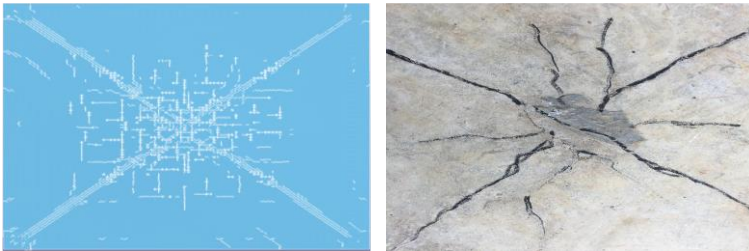
Hình 3.23. Hình thành vết nứt mặt dưới tấm BTCT (TN_01)
