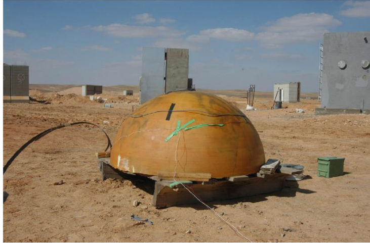
Hình 1.12. Thí nghiệm kết cấu chịu áp lực nổ của Schenker [37]
