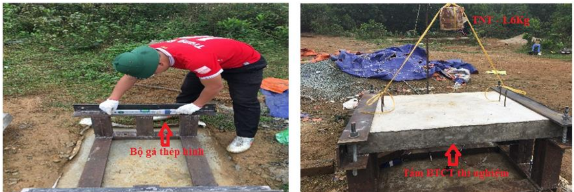
Hình 3.20. Thí nghiệm kết cấu BTCT chịu tác dụng của nổ gần
