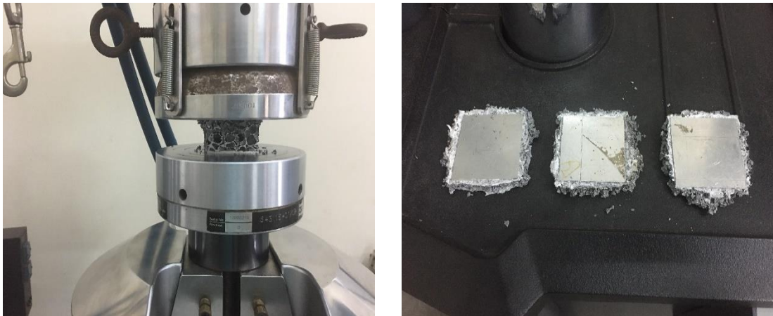
Hình 4.30. Thí nghiệm nén đơn trục mẫu nhôm bọt
