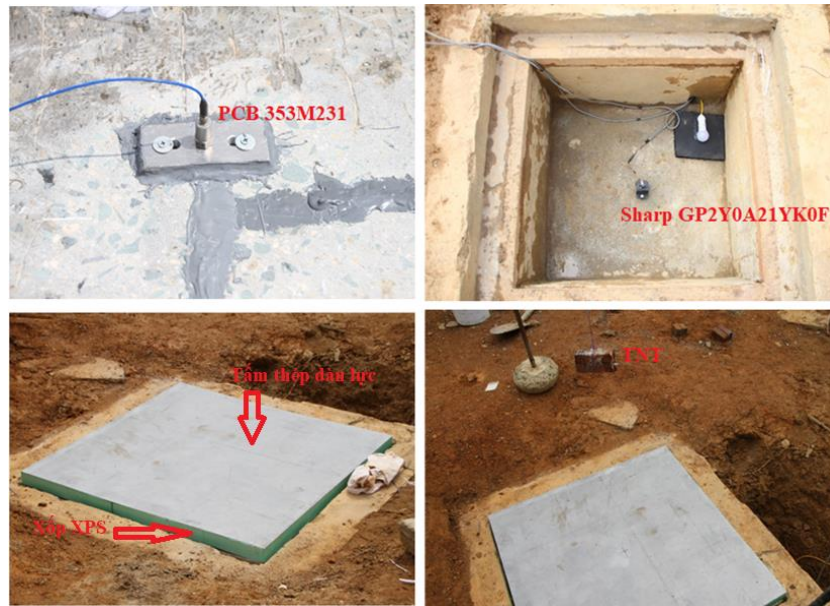
Hình 4.2. Kết cấu thí nghiệm hiện trường
