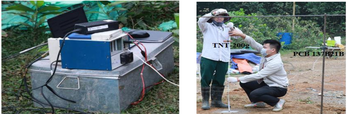
Hình 3.2. Bố trí thí nghiệm đo áp lực nổ không khí hiện trường
