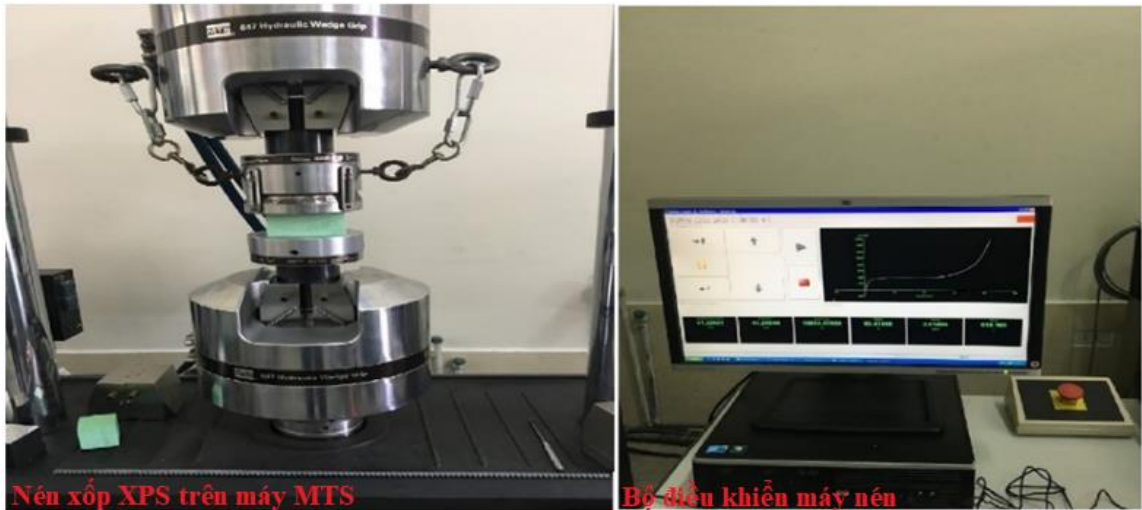
Hình 2.15. Quá trình tiến hành thí nghiệm nén mẫu xốp XPS
