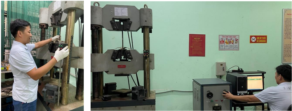
Hình 3.18. Thí nghiệm mẫu cốt thép
