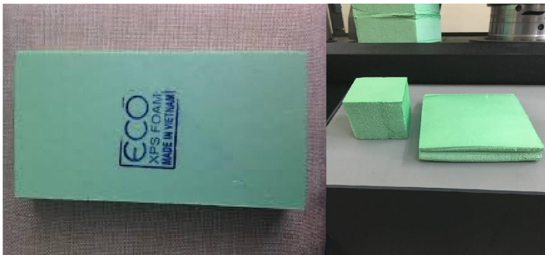
Hình 2.14. Mẫu xốp XPS trong thí nghiệm nén
