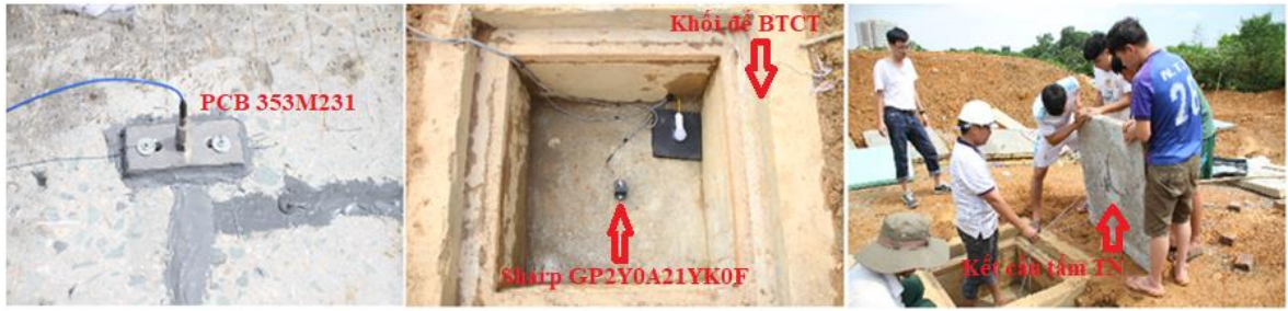
Hình 3.19. Thí nghiệm xác định đặc trưng động học tấm BTCT
