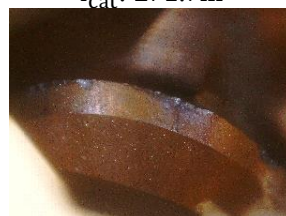
Thí nghiệm 3 - 45° l cắt : 237.6m
