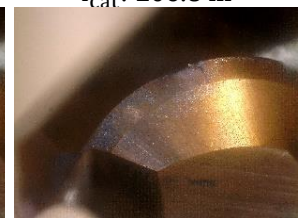
Thí nghiệm 12 - 30° l cắt : 143.0 m
