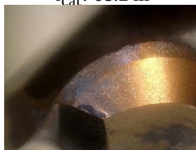
Thí nghiệm 12 - 30° l cắt : 47.3 m
