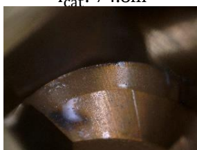
Thí nghiệm 5 - 30° l cắt : 136.4m
