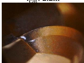
Thí nghiệm 6 - 15° l cắt : 2.2m
