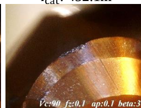
Thí nghiệm 2 - 30° l cắt : 383.9m
