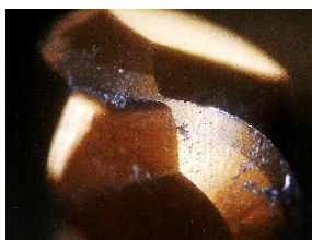
Thí nghiệm 1 - 15° l cắt : 165.0m
