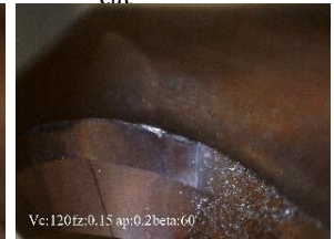
Thí nghiệm 10 - 60° l cắt : 125.4 m
