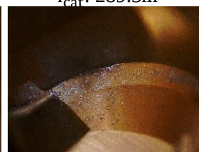
Thí nghiệm 6 - 15° l cắt : 262.9m
