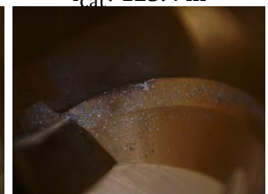
Thí nghiệm 11 - 15° l cắt : 206.8 m
