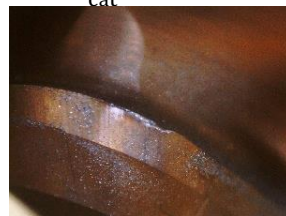
Thí nghiệm 4 - 60° l cắt : 158.4m
