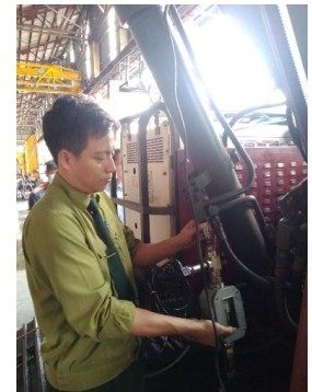
Hình 4.6. Lắp đặt cảm biến áp suất và cảm biến lưu lượng
