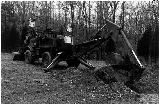
Hình 1.2. Máy đào thủy lực điều khiển từ xa của nhóm Burks
