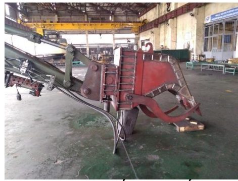
Hình 4.2. Cơ cấu đào đất – kẹp bom
