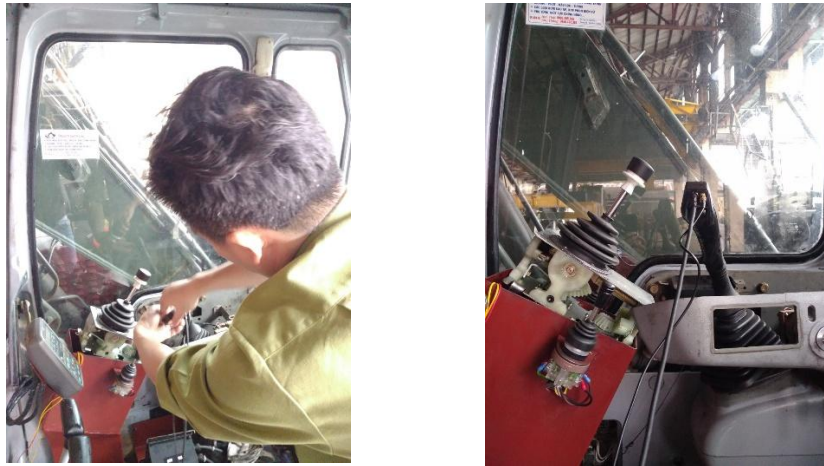
Hình 4.11. Lắp đặt cảm biến DS-IMU1 trên các tay trang
