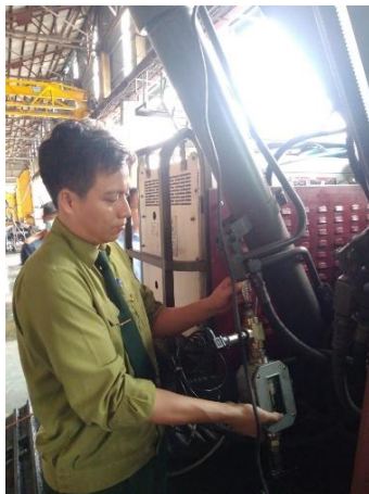
Hình 4.13. Lắp đặt cảm biến áp suất và cảm biến lưu lượng
