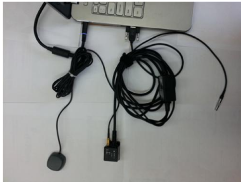
Hình 4.9. Phương pháp kết nối cảm biến DS-IMU1 với máy tính
