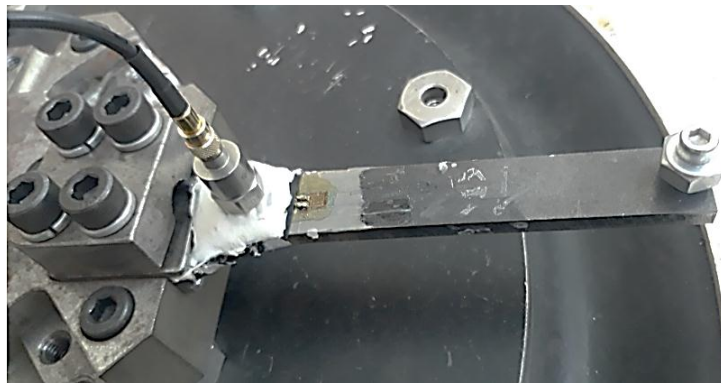
Hình 4. 10: Gá đặt chi tiết mẫu cần tìm tần số dao động riêng trên đầu rung.
