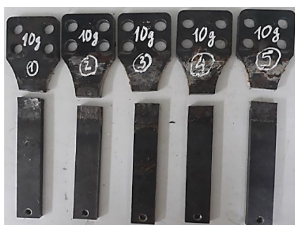
Hình 4. 22: Nhóm chi tiết mẫu rung với biên độ gia tốc 99,5 \text{ m/s}^2 (x là chi tiết mẫu hỏng và 0 là chi tiết mẫu chưa hỏng)
