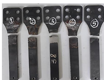
Hình 4. 17: Nhóm chi tiết mẫu không rung khử ứng suất dư. (x là chi tiết mẫu hỏng và 0 là chi tiết mẫu chưa hỏng)
