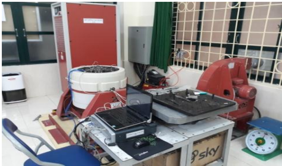
Hình PL10.6: Hệ thống thử nghiệm rung xóc LDS
