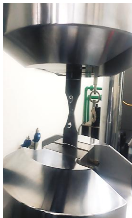
Hình 4. 6: Kéo chi tiết mẫu xác định đặc tính cơ học tĩnh.
