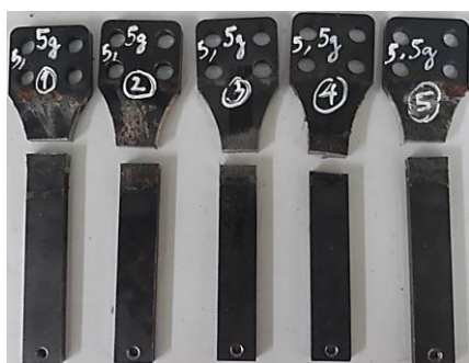
Hình 4. 20: Nhóm chi tiết mẫu rung với biên độ gia tốc 57,4 \text{ m/s}^2 (x là chi tiết mẫu hỏng và 0 là chi tiết mẫu chưa hỏng)
