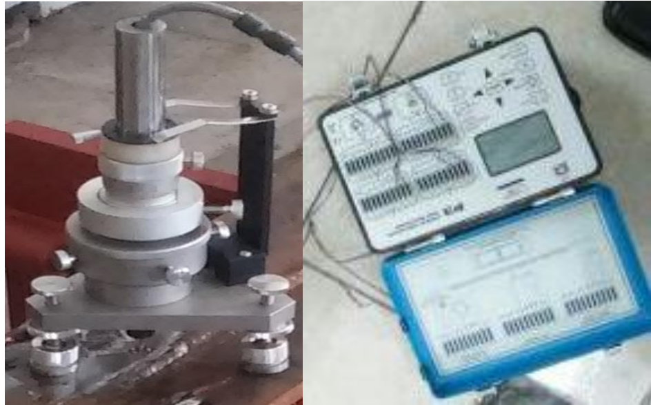
Hình PL10.7: Máy đo ứng suất dư kiểu khoan lỗ
