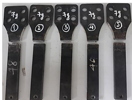
Hình 4. 21: Nhóm chi tiết mẫu rung với biên độ gia tốc 71,4 \text{ m/s}^2 (x là chi tiết mẫu hỏng và 0 là chi tiết mẫu chưa hỏng)
