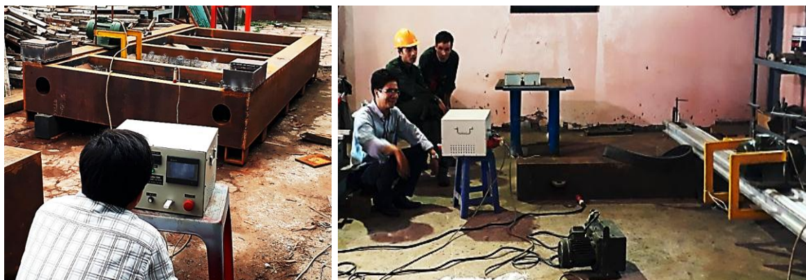
Hình 1. 10: Rung khử ứng suất dư tại Việt Nam
