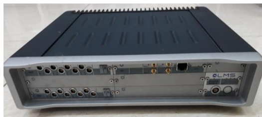
Hình PL10.2: Hệ thống đo rung, ồn, ứng suất-biến dạng LMS
