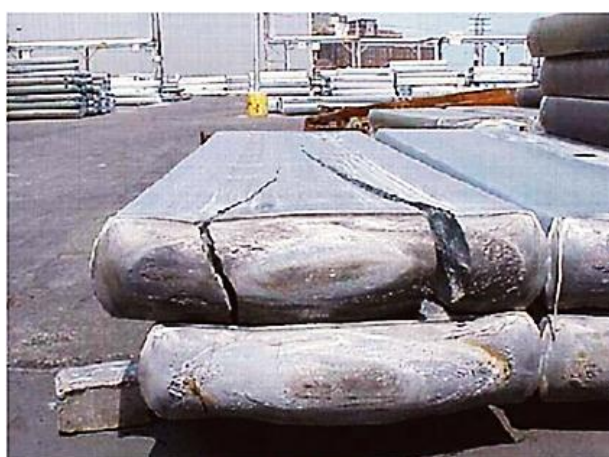
Hình 1. 3: Sự nứt trong thỏi nhôm đúc do ứng suất dư [29]
