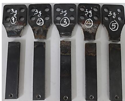
Hình 4. 18: Nhóm chi tiết mẫu rung với biên độ gia tốc 29,2 \text{ m/s}^2 (x là chi tiết mẫu hỏng và 0 là chi tiết mẫu chưa hỏng)
