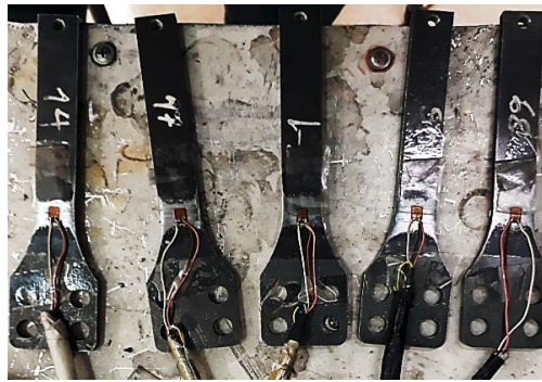
Hình 4. 8: Tem đo biến dạng được dán trên chi tiết mẫu.
