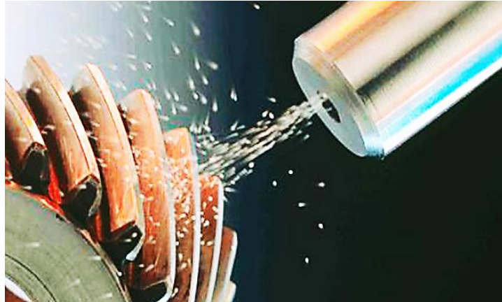
Hình 1. 8: Phun bi xử lý bề mặt [56]
