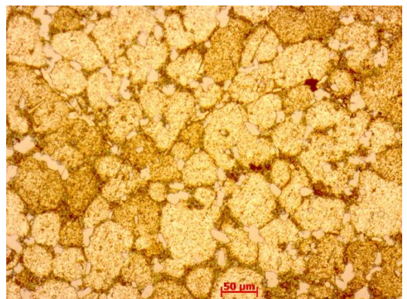
Thí nghiệm N°6 (x100) 600 °C, 300 mm, 65 °
