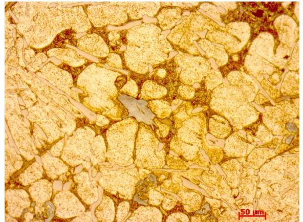
Thí nghiệm N°18 (x100) 590 °C, 450 mm, 55 °
