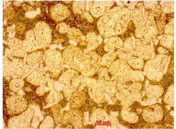
Thí nghiệm N°2 (x100) 600 °C, 300 mm, 45 °
