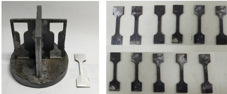
Hình 4.9. Kích thước phôi thử kéo theo TCVN 197-1:2014
