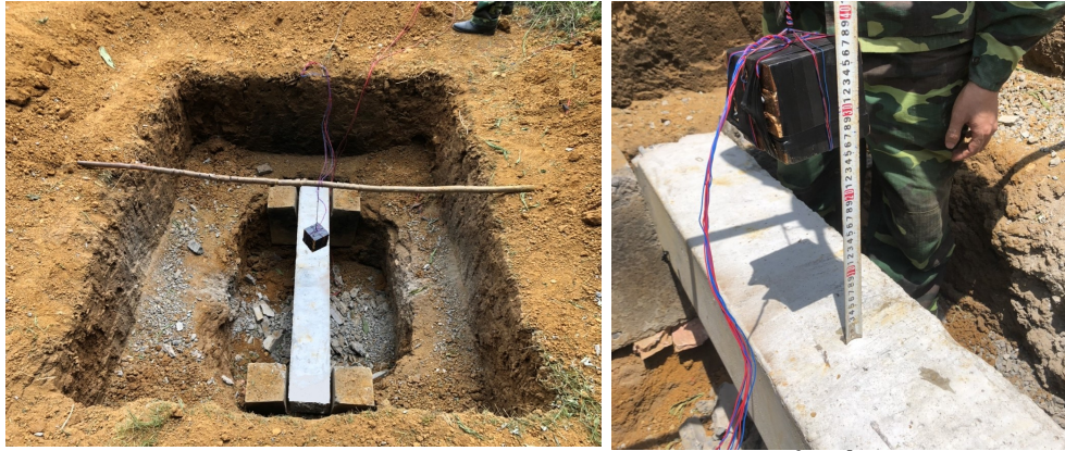
Hình 3.3. Mô hình thử nghiệm nổ gần
