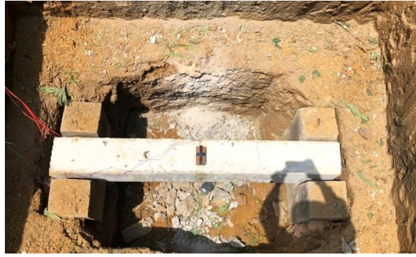
Hình 3.2. Mô hình thử nghiệm nổ tiếp xúc
