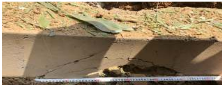
Hình 3.24. Chiều dài vùng chấn sục của cấu kiện BTCT sau khi nổ gần
