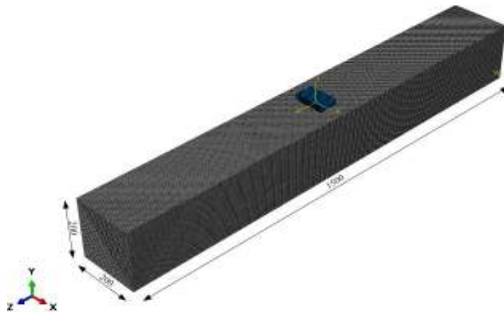
Hình 3.28. Chia lưới phần tử cấu kiện BTCT nổ tiếp xúc
