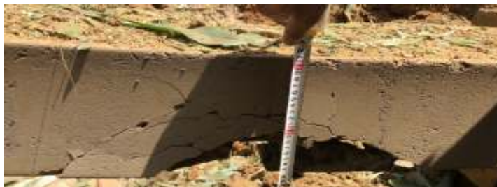
Hình 3.25. Chiều cao vùng chấn sục của cấu kiện BTCT sau khi nổ gần
