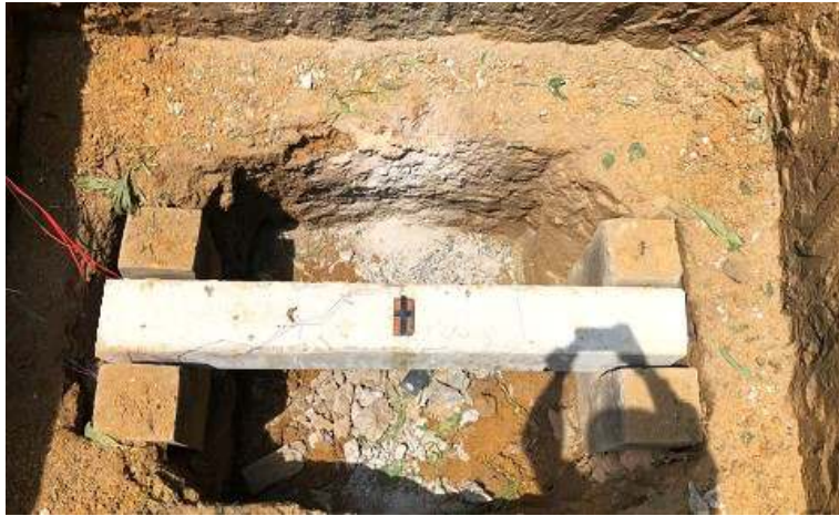
Hình 3.10. Mô hình thử nghiệm nổ tiếp xúc
