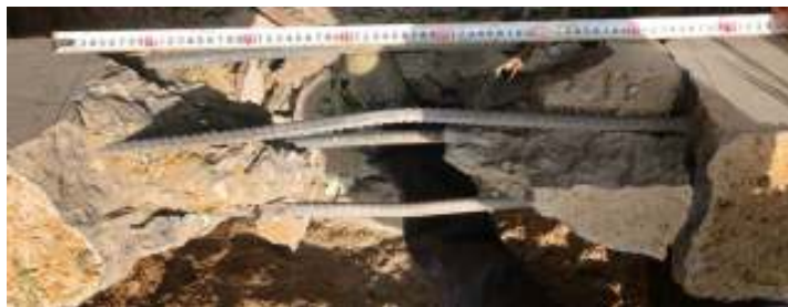
Hình 3.19. Cấu kiện BTCT số 3 bị phá hủy sau khi nổ tiếp xúc
