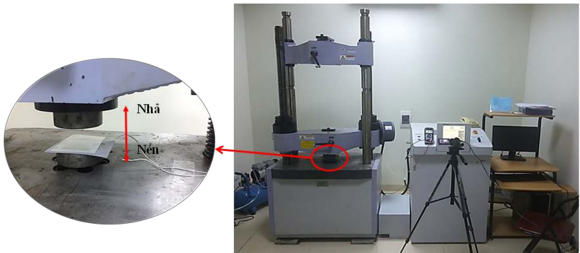
Hình 2.5: Thí nghiệm khảo sát đặc tuyến cảm biến.
