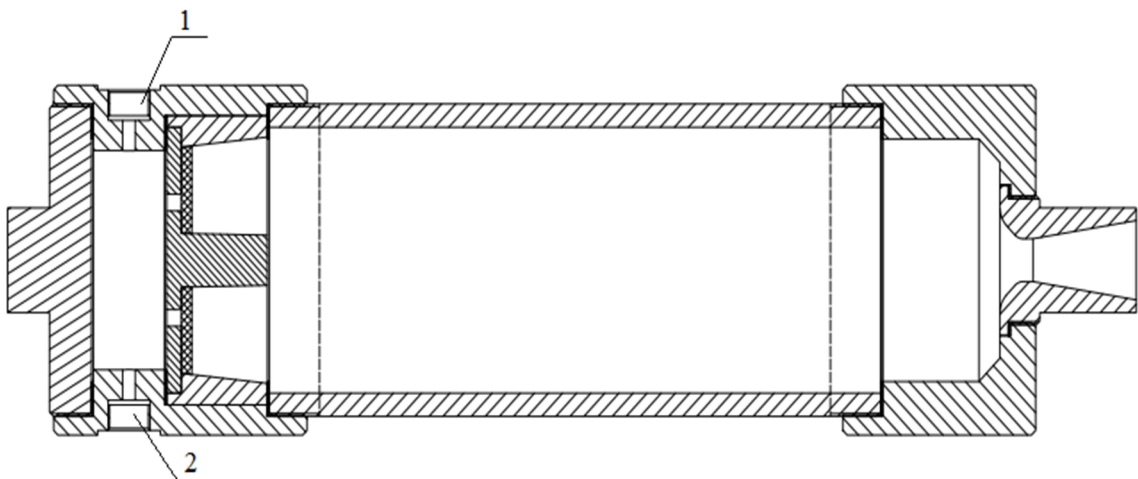
Hình 3.19. Sơ đồ thử nghiệm xác định áp suất mở thông vách ngăn
