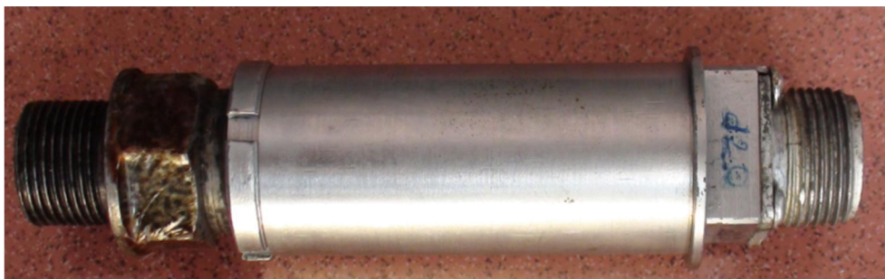
Hình 3.9. Cảm biến đo áp suất động cơ tên lửa DA-10-08
