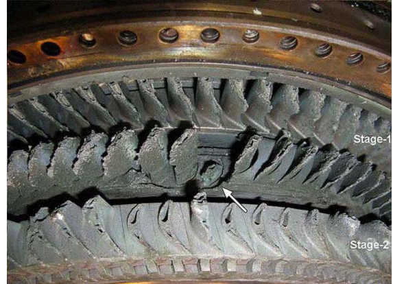
Hình 1.5. Tuabin động cơ Honeywell LF507 bị phá hủy do cháy CPCA [15]
