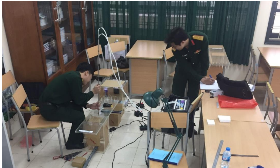
Hình PL5- 1. Đo độ đồng đều của vận tốc dòng ngang
