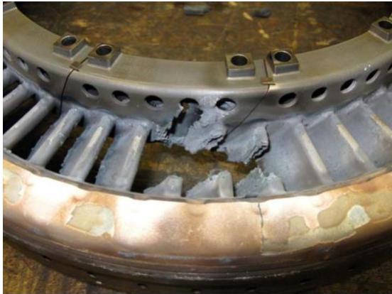
Hình 1.4. CPCA động cơ Honeywell LF507 bị cháy ở vị trí 6 giờ [15]
