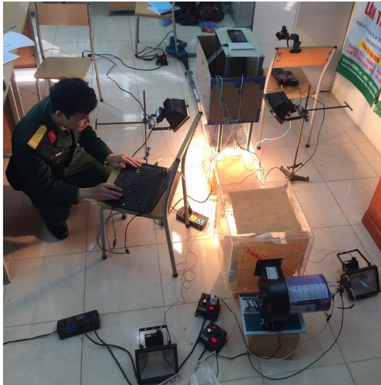
Hình PL5- 4. Điều khiển đèn bằng code xây dựng trên phần mềm LabVIEW
