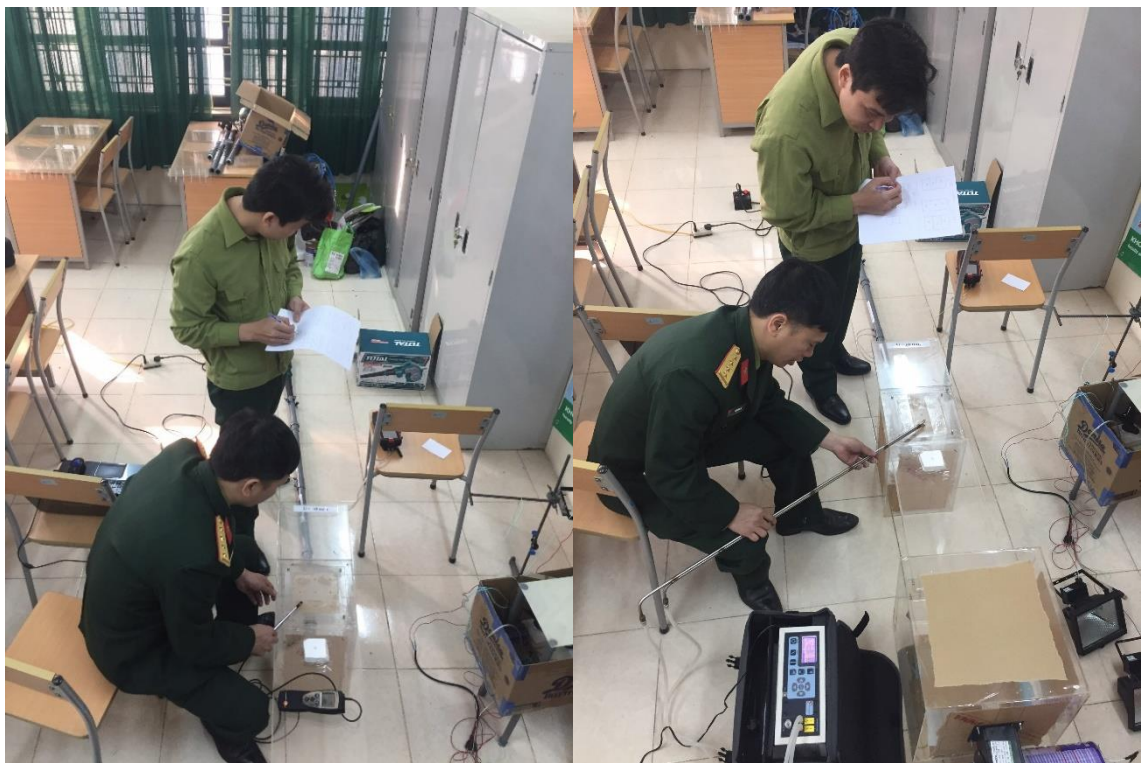
Hình PL5- 2. Đo độ đồng đều của lưu lượng không khí phun ra khỏi các lỗ phun bằng thiết bị Testo 425 và E Instruments E8500 plus
