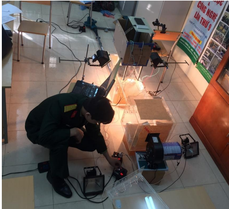
Hình PL5- 3. Điều chỉnh vận tốc dòng ngang bằng bộ điều chỉnh công suất cho quạt thổi
