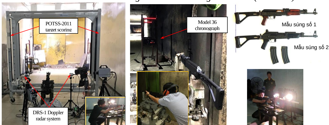
Hình 4.17. Sơ đồ bố trí các thực nghiệm bắn đo sơ tốc trong không khí
