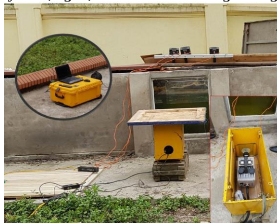
Hình 4.24. Hình ảnh bố trí thực nghiệm đo chuyển động của BKN khi bắn dưới nước
