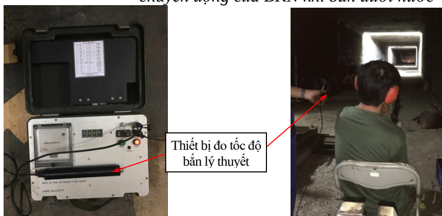
Hình 4.28. Hình ảnh bố trí thực nghiệm đo tốc độ bắn lý thuyết trong không khí bằng thiết bị đo Rate of recorder type 422FP
