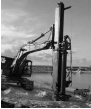
Hình 4.3. Bộ công tác lắp trên máy xúc PC-450 làm thực nghiệm tại đảo Trường Sa lớn
