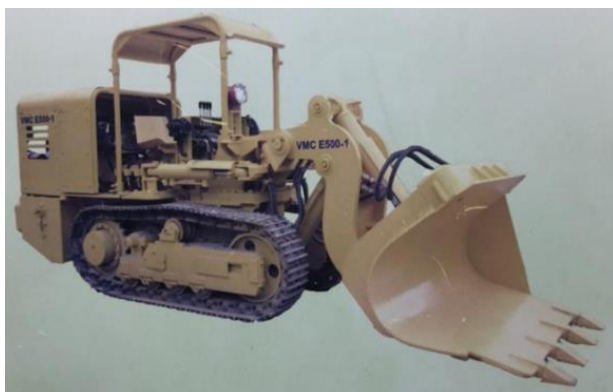
Hình 2.1. MXLDB phục vụ bốc xúc trong thi công đường hầm khẩu độ vừa và nhỏ.
