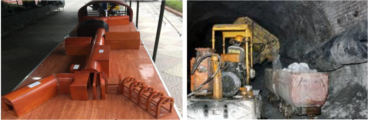
a) Mô hình đường hầm quân sự a) MXLĐB làm việc trong đường hầm Hình 1.2. Mô hình đường hầm quân sự và thiết bị bốc xúc trong đường hầm
