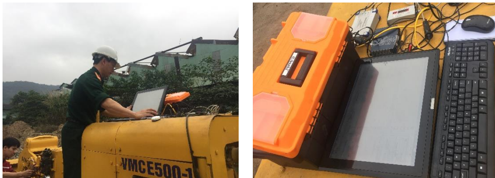
Hình 4.18. Gắn thiết bị định vị GPS trên máy xúc
