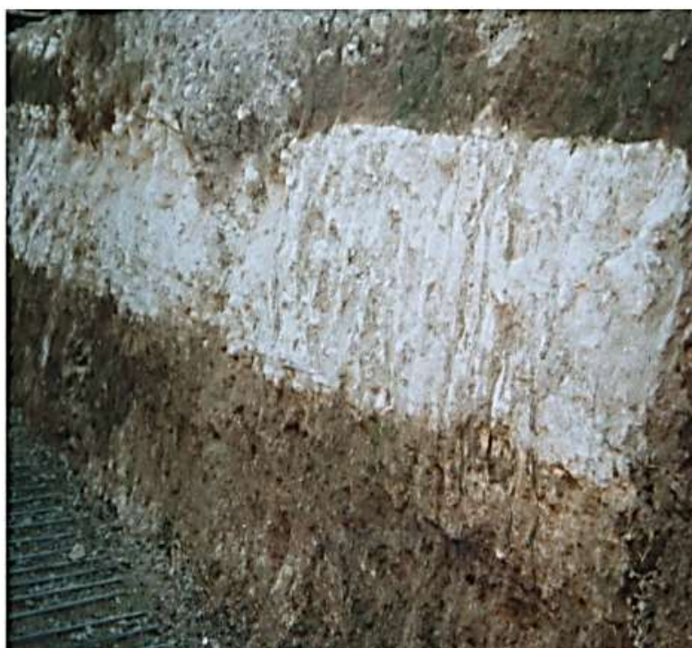
Hình 1.2. Phân lớp địa tầng nền san hô [5]
