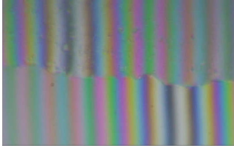
Hình 4.7: Hình ảnh giao thoa thu được tại biên lớp màng dày 1200 nm
