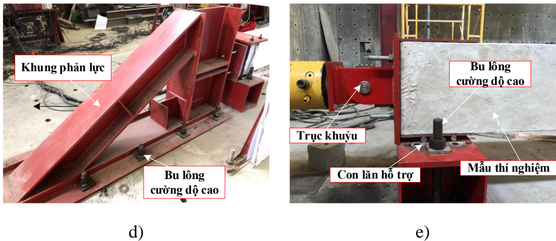
Hình 2.17 Bố trí thiết bị thí nghiệm
