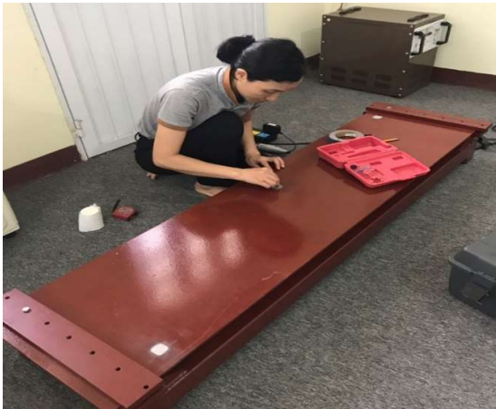
a, Gắn cảm biến gia tốc
