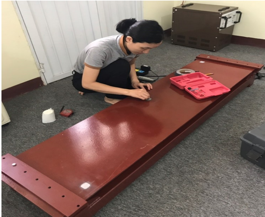
a) Gắn cảm biến gia tốc
