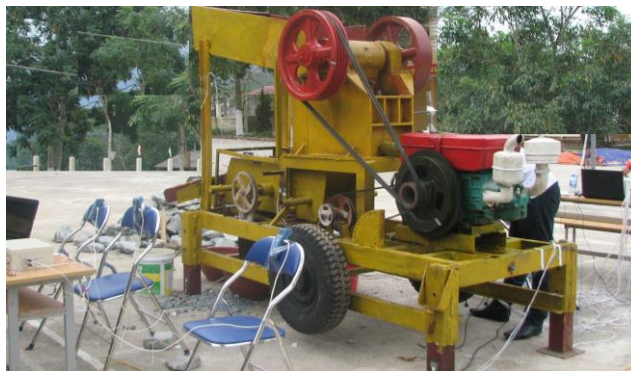
Hình 4.2. Hình thể hiện lắp các đầu đo lên tổ hợp nghiền sàng di động
