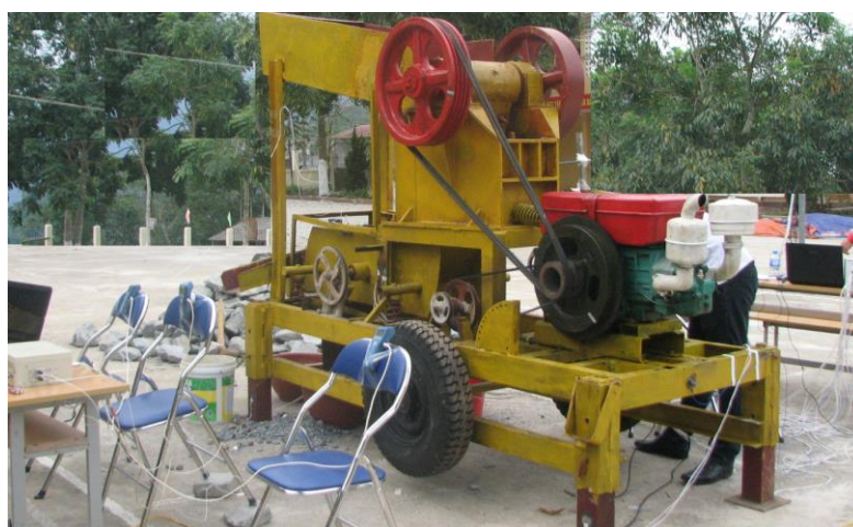
Hình 4-9. Hình thể hiện lắp các đầu đo lên tổ hợp nghiền sàng di động
