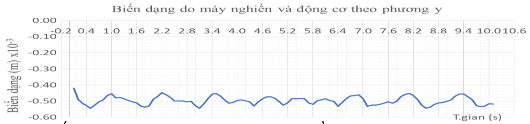
Hình 2-8. Biến dạng do tác động của máy nghiền và động cơ theo phương đứng (phương y)
