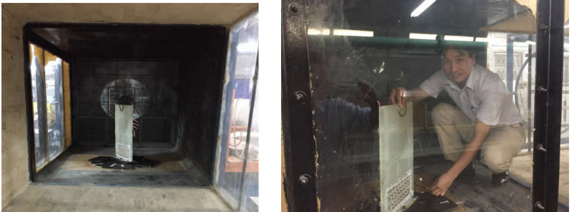
Hình 4.10. Lắp đặt mẫu thí nghiệm trong hầm gió
