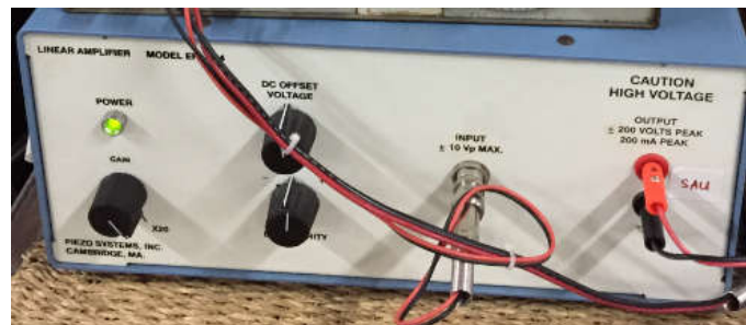
Hình 4.13. Điện áp V_{in} = 9,30\text{V} , tần số kích thích f = 6,944\text{Hz} được khuếch đại lên 20 lần
