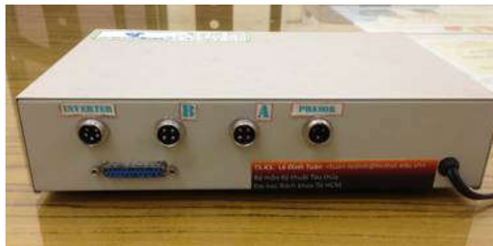
Hình 4.5. Bộ thu nhận dữ liệu 2 kênh áp điện HnB75B
