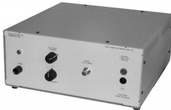
Hình 4.4. Bộ khuếch đại piezo tuyến tính EPA-104-230
