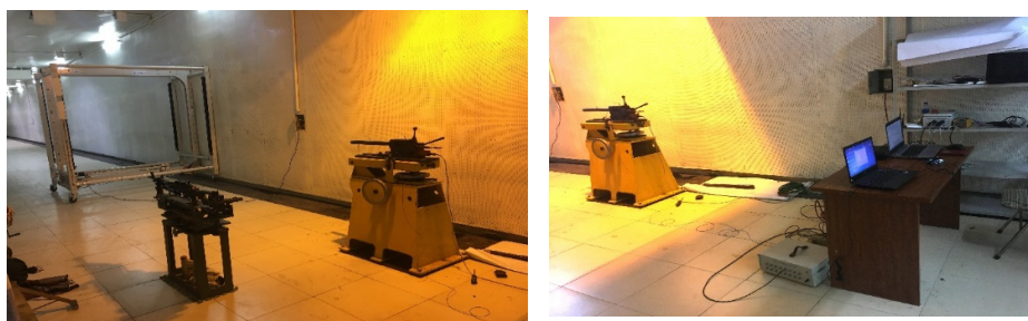
Hình 4.1: Bố trí thử nghiệm đo áp suất trong nòng, dịch chuyển của pít tông bộ khóa, sơ tốc đầu đạn
