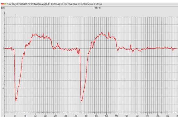
Hình 4.9. Quy luật vận tốc lùì dọc trục nòng của nòng phải
