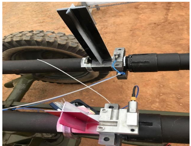
Hình 4.6. Đồ gá và cảm biến gia tốc một chiều gắn trên nòng bên phải
