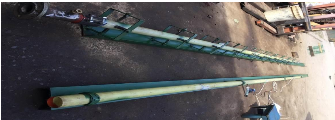
Hình 4.1. Mô hình thí nghiệm ống composite đặt trên gối cứng và gối đàn hồi
