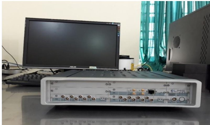
Hình 4.5. Hệ thống đo động 16 kênh LMS và màn hình làm việc của máy
