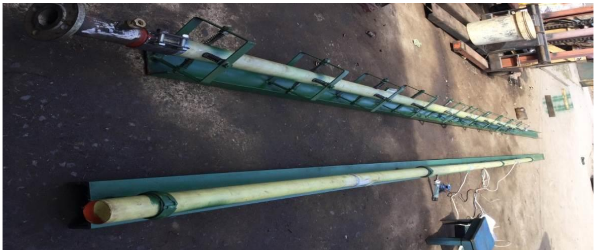
Hình 4.1. Mô hình thí nghiệm ống composite đặt trên gối cứng và gối đàn hồi 4.4.1.2. Mẫu thí nghiệm
