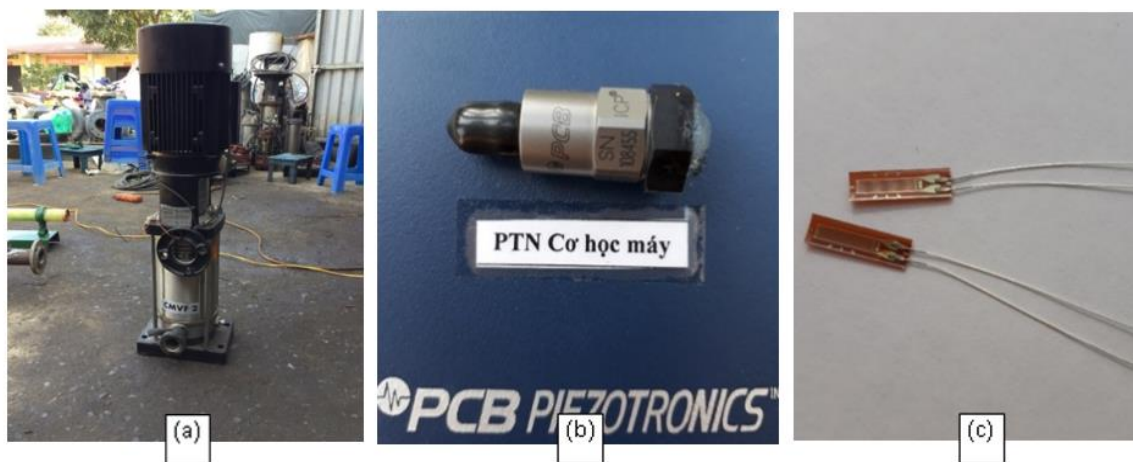
Hình 4.4. Thiết bị gây tải (a), cảm biến gia tốc (b), đầu đo biến dạng (c)
