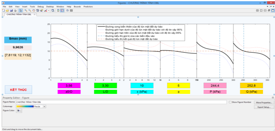
Hình 4.23: Giao diện biểu diễn kết quả dự đoán độ lún mặt đất lớn nhất trường hợp đào đường hầm tuyến đôi bằng khiên đào.
